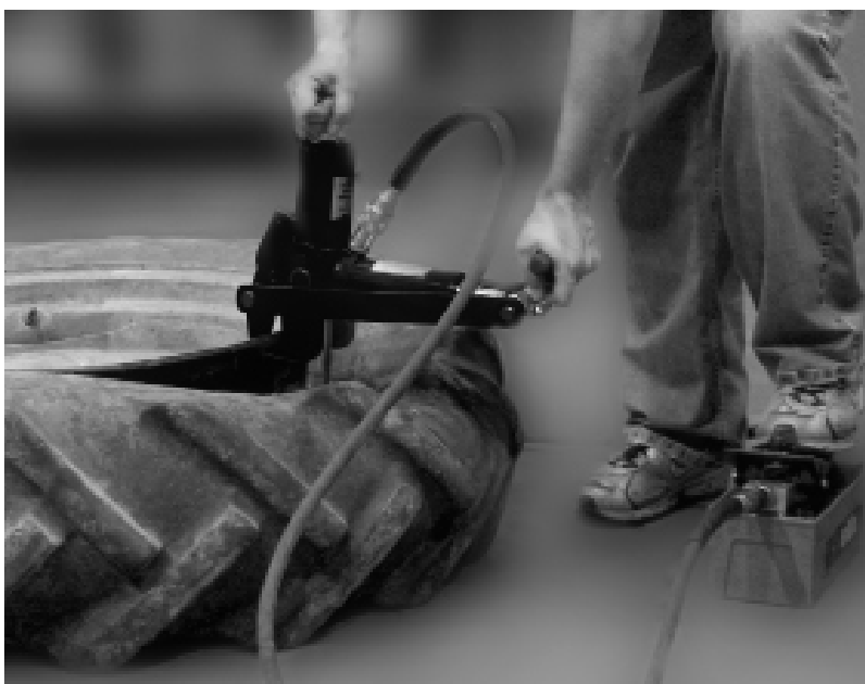
Figure 3 : Utilisation du démonte-pneus
